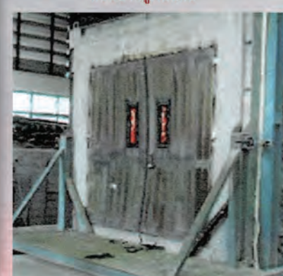
รูปผลการทดสอบ การทนไฟ 3 ชม. แบบบานคู่พร้อมกระจกทนไฟ
