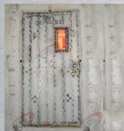
รูปผลการทดสอบ การทนไฟ 4 ชม. แบบบานเดี่ยวพร้อมกระจกทนไฟ
